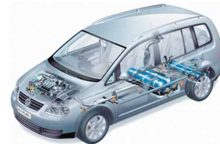
Schnitt des VW Touran Eco Fuel.
